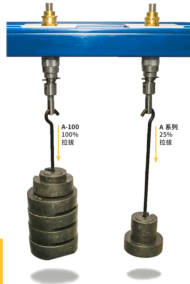
拉拔阻力试验中的 CMP A-100 和标准 A 系列电缆密封接头。
