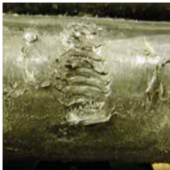
螺纹接触造成的微小电缆损伤
